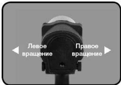
Рисунок 3: Установка направления вращения
