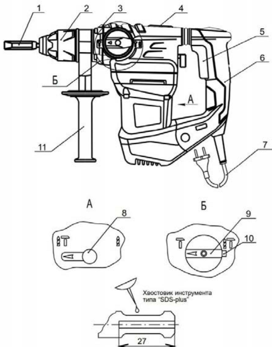
1 - инструмент; 2 - стакан; 3 - редуктор; 4 - крышка; 5 - клавиша выключателя; 6 - рукоятка; 7 - шнур питания; 8 - переключатель режимов работы (отключение удара); 9 - переключатель режимов работы (отключение сверления); 10 - фиксатор; 11 - ручка.
