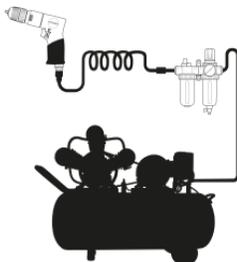
Sämtliche Steuerelemente, Verbindungsleitungen und -schläuche müssen für den Solldruck und Luftvolumenstrom ausgelegt sein. Vermeiden Sie die Verengung der Zuführungsleitungen, z.B. durch abgequetschte, geknickte bzw. ausgedehnte Stellen. Vor dem Anschluss des Schlauches an den Werkzeug blasen Sie den Schlauch regelmäßig aus, um Reste der Feuchtigkeit aus dem Schlauch zu entfernen.
