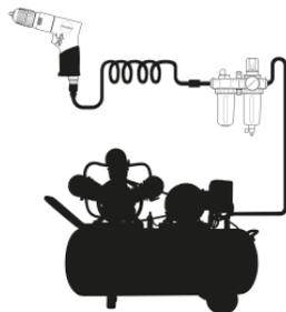
Все управляющие элементы, соединительные линии и шланги должны быть рассчитаны на необходимое давление и объемный расход воздуха. Не допускайте сужения подводящих линий, например, в результате пережатия, перегибов или растягивания. Перед подключением шланга к инструменту периодически продувайте шланг мощным напором воздуха для удаления влаги из шланга.
