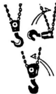
Рис. 6 Неправильное положение крюка.
