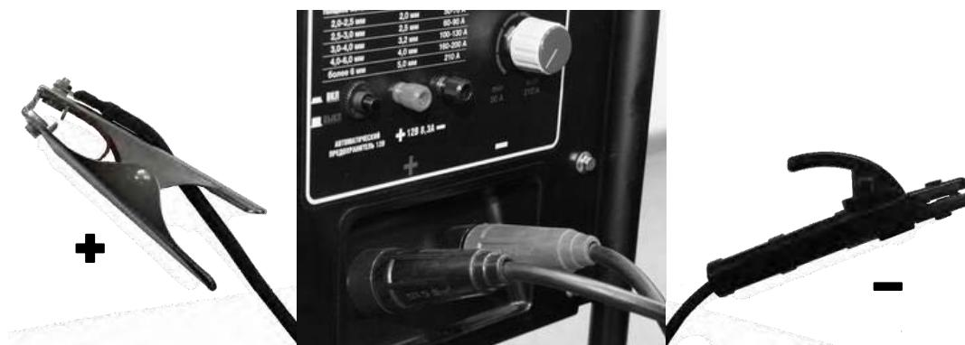
Обратная полярность применяется для сварки тонколистовой (до 2,5 мм) стали. Такая полярность обеспечивает небольшую глубину проваривания и большую высоту сварочного шва.
