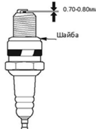
1. Отсоедините колпачок свечи зажигания и удалите грязь вокруг свечи зажигания.
