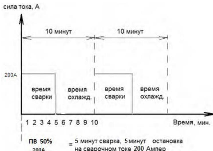
График продолжительности полного цикла работы сварочного генератора
