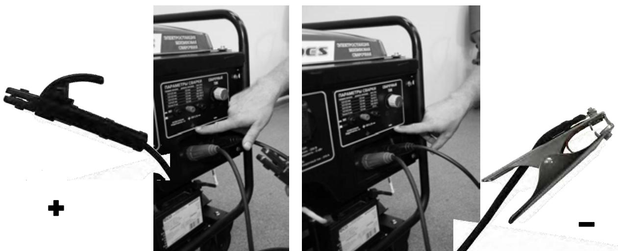
Прямая полярность применяется для сварки толстолистовой стали. Такая полярность обеспечивает большую глубину проваривания и более низкую высоту сварочного шва.
