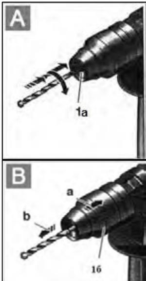
Патрон модели ВН 3601 предусматривает закрепление инструмента с хвостовиком типа "SDS plus". Патрон модели ВН 4001 — типа "SDS MAX".
