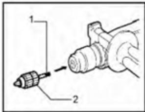
Чтобы можно было работать с инструментами без хвостовика типа „SDS-plus“ (напр., для работы сверлами с цилиндрическим хвостовиком), необходимо установить сверильный патрон кулачкового типа, снабженный хвостовиком типа „SDS-plus“ или при использовании специального адаптера.
