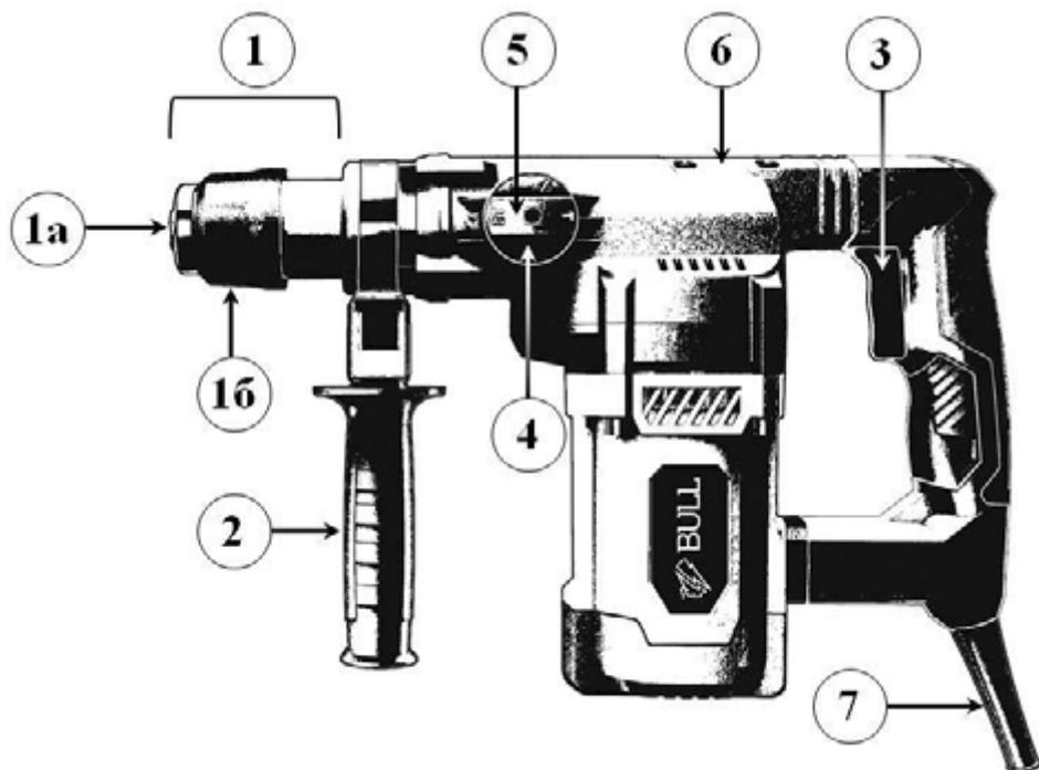
**1** Патрон для приёма инструмента SDS-plus
