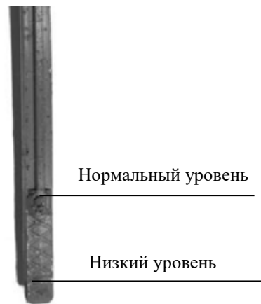
Рисунок 5 – Проверка уровня масла в корпусе редуктора
