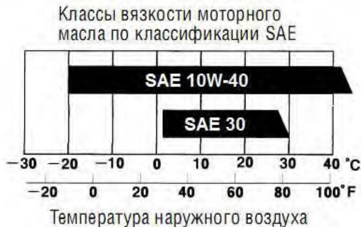
Рисунок 3 – Классы вязкости масла по классификации SAE
