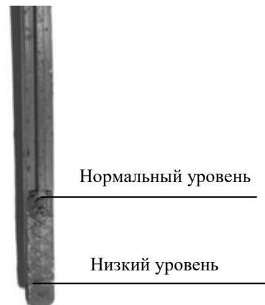
Рисунок 5 – Проверка уровня масла в корпусе редуктора
