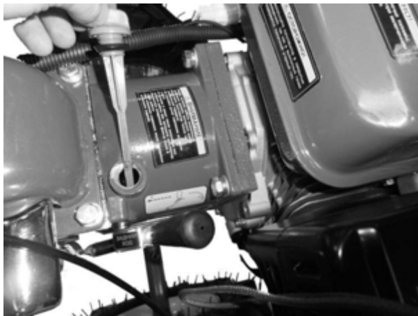
Рисунок 5 – Проверка уровня масла в корпусе редуктора
