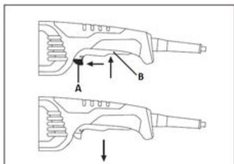
Для **включения** прибора возьмитесь рукой за основную рукоятку, снимите с блокиратора случайного нажатия А, затем нажмите клавишу включения В, при необходимости зафиксируйте ее во включенном положении при помощи блокиратора случайного нажатия А. Для **выключения** прибора снимите с фиксации во включенном положении клавишу включения, нажмите и отпустите клавишу В, как показано на изображении слева.
