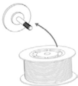
5. Наденьте катушку типа D 100 на шток
