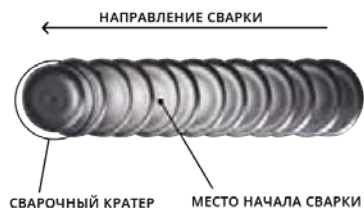
Рис. 12.4. Начало сварки при смене электрода.
