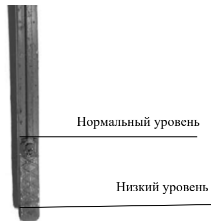
Рисунок 6 – Проверка уровня масла в корпусе редуктора
