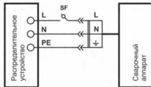
**Примечание:** символ – обозначение провода заземления. Данный провод имеет желто-зеленую маркировку изоляции.
