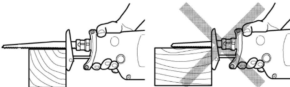
Кроме того, при распиле заготовок, чья толщина (или диаметр) превышает длину пильного полотна, возникает опасность, что пильное полотно застрянет во внутренней стенке трубы или внутри деревянного блока, что может привести к повреждению пильного полотна.
