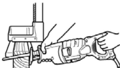
Г) Удобно взяться рукой за рукоятку пилы сабельной. Указательный палец должен находиться на выключателе ВКЛ/ВЫКЛ (4). Второй рукой возьмитесь за корпус пилы в области фиксатора пильного полотна, как изображено на рисунке выше.
