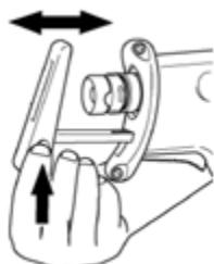
Если эффективность резки пильного полотна снизится, переместите башмак (2), чтобы использовать острую, неиспользованную часть пильного полотна. Это поможет продлить срок службы полотна. Так же, регулировка вылета башмака производится в зависимости от размеров обрабатываемой заготовки.
