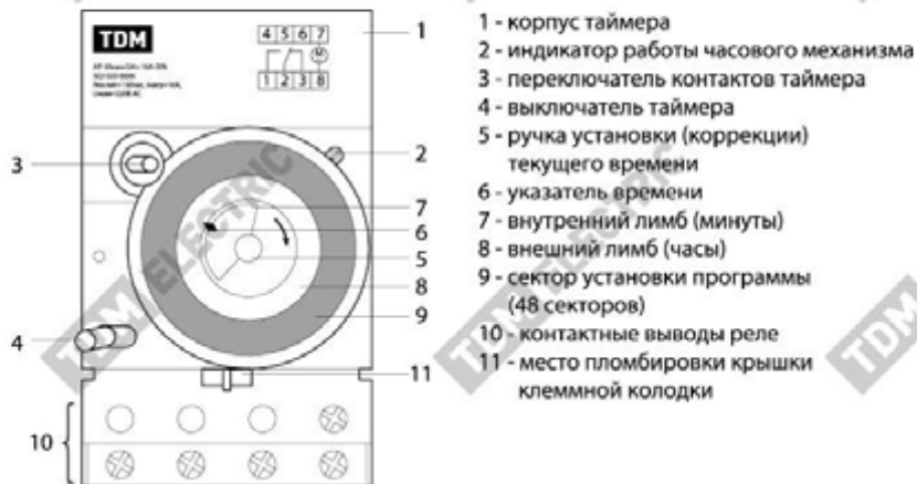
Рисунок 4. Элементы управления реле AP
