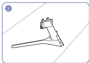
Проверьте, надежно ли закреплен соединительный элемент подставки.
