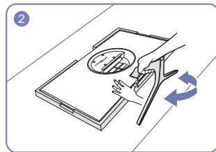
Чтобы отсоединить подставку от монитора, обязательно нажмите на нижнюю часть монитора одной рукой и потяните подставку другой рукой в направлении стрелки, чтобы создать некоторый зазор между ними.
