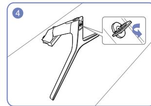
Извлеките соединительный элемент из подставки, повернув винт в направлении стрелки, как показано на рисунке.
