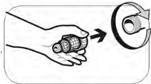
Для подключения очистителя к водопроводной сети можно использовать поливочный шланг диаметром не менее 1/2 дюйма (допускается использовать шланги диаметром 5/8 и 3/4 дюйма).
