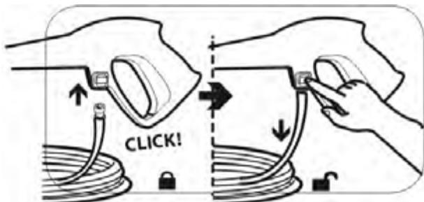
Ниппель высоконапорного шланга вставьте до щелчка в быстросъемное гнездо рукоятки моющего пистолета (8). Перед началом работы с очистителем убедитесь, что высоконапорный шланг полностью размотан и не имеет петель по всей длине. Следите, чтобы во время работы очистителя высоконапорный шланг не образовывал петли. Это может оказаться на
