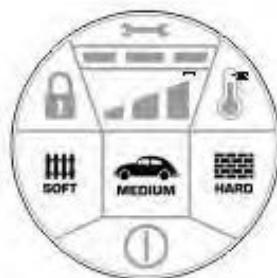
Специально разработанная запатентованная технология **DIGITAL CONTROL PROGRAM** в модели **HPW-1860RSD** позволяет регулировать мощность устройства, тем самым еще более снижается потребление воды, увеличивается ресурс электродвигатели и сокращается потребление электроэнергии. На выбор предлагается 3 программы: **SOFT** (50% мощности); **MEDIUM** (75% мощности); **HARD** (100% мощности);
