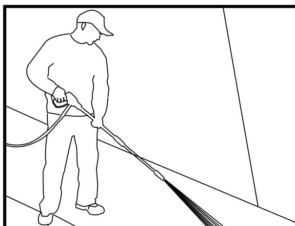
Распыление воды под таким углом обеспечивает оптимальную силу контакта струи с очищаемой поверхностью в сочетании с максимально эффективным удалением грязи.
