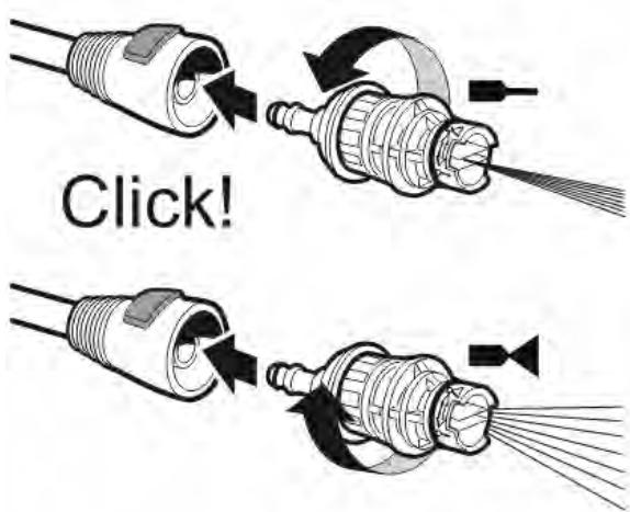
Установите головку веерной форсунки в удлинительную насадку. Головка фиксируется быстро-съемным соединением. Для того, чтобы извлечь головку, нажмите на кнопку и достаньте головку.
