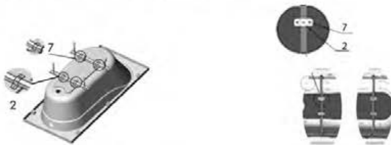
Рисунок 5 – фиксация ножек ванны
