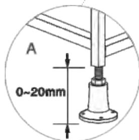
A. Установите поддон на штатное место. При помощи строительного уровня отрегулируйте высоту пластиковых опор так, чтобы поддон стоял строго горизонтально (во избежание застаивания воды на дне изделия).
