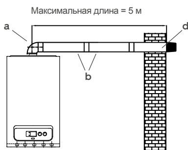
Рисунок 15 Монтаж дымохода с одним угловым отводом 90°.
