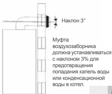
Рисунок 9. Наклон конденсора
