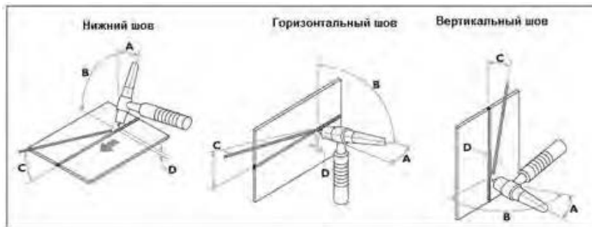
Рисунок 25. Базовые движения при работе с аргодуговой горелкой
