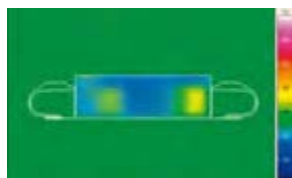
Термограмма с технологией GROHE CoolTouch®
