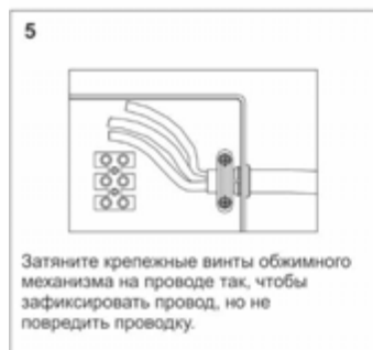
Рис.4 Подключение кабеля питания
