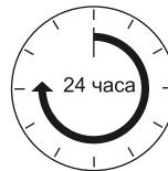
Не рекомендуется эксплуатация изделия в течение 24 часов с момента установки (до полного высыхания герметика).
