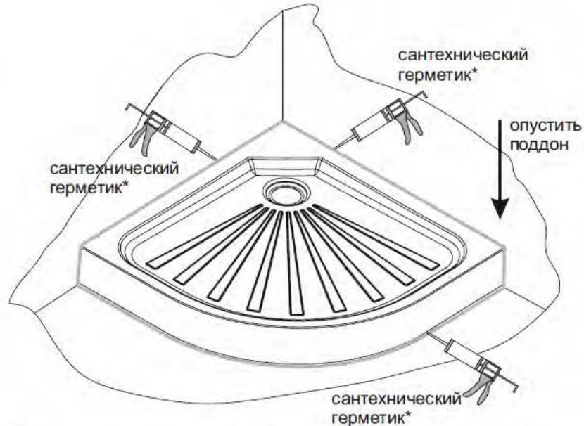
После монтажа душевого поддона на выбранное место, нагрузить его грузом весом около 50кг. и выждать 24 часа.
