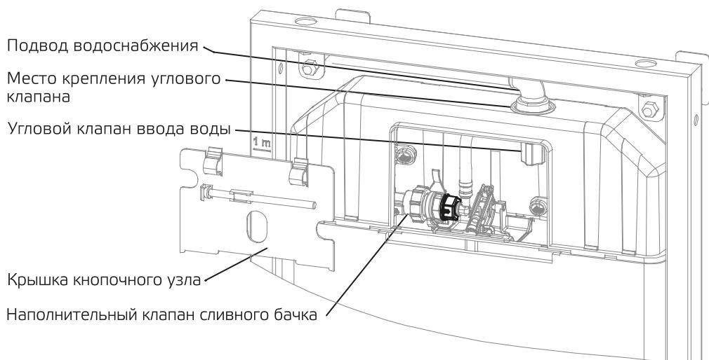
6. После выполнения всех этапов установки инсталляция теперь закреплена к стене и соединена с основной системой водоснабжения и канализации. Чтобы предотвратить проблемы загрязнения во время процесса цементирования или укладки плитки установите на время монтажа: заглушку впускной трубы, заглушку смывной трубы, защиту шпилек и защитный кожух кнопочного узла.
