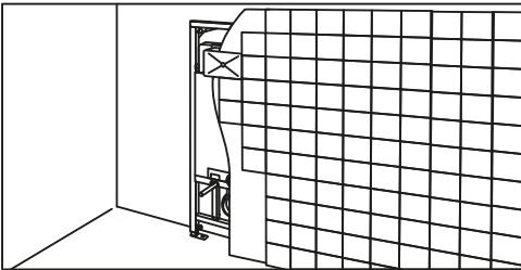
2. Произведите обшивку места установки системы подачи воды (руководствуйтесь допусками завода изготовителя системы подачи воды).
