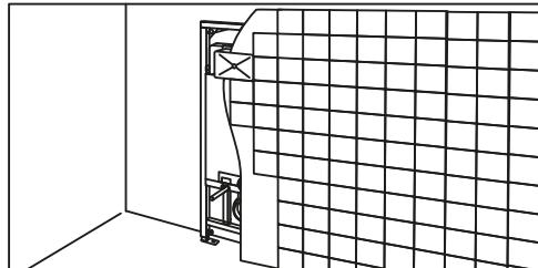
2. Произведите обшивку места установки инсталляционной системы (руководствуйтесь допусками завода изготовителя инсталляции).
