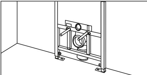
1. Установите, закрепите, отрегулируйте инсталляционную систему согласно инструкции по монтажу (поставляется в комплекте с инсталляцией). Надёжно соедините отвод инсталляционной системы с канализацией и подведите систему водоснабжения.
