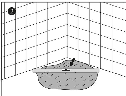
Место предполагаемой сборки поддона необходимо выровнять. Это можно сделать при помощи бетонной стяжки, используя уровень.
