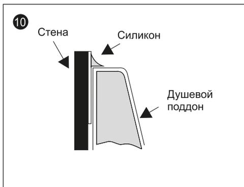
Соединяемые поверхности должны быть чистыми и сухими. Заполните места соединения поддона и стены санитарным силиконом. После завершения сборки снимите защитную пленку с остальной части поддона.
