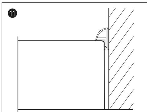
Помимо герметизации поддона санитарным силиконом, мы рекомендуем использовать отделочные пластиковые уголки между поддоном и стеной ванной комнаты, наложенные на санитарный силикон.
