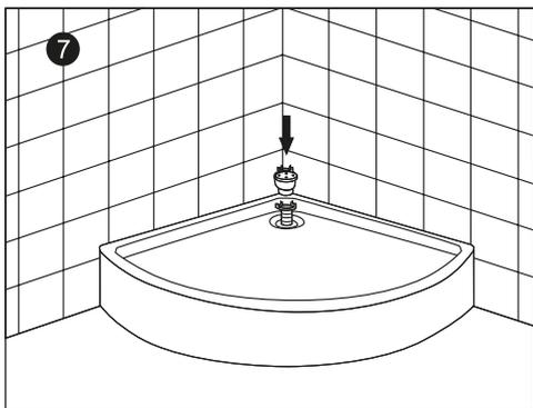
Снимите защитную плёнку с краёв поддона, соприкасающихся с полом и стенами, затем установите верхнюю часть сливного сифона.
