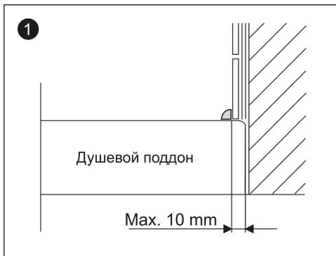
**Внимание:** мы рекомендуем осуществлять сборку поддона в углу ванной комнаты, чтобы в том числе, закрепить поддон к стенам облицованным керамической плиткой. В случае установки поддона "под плитку", она должна закрыть стену с запасом, таким образом, чтобы плитка накладывалась на край поддона, при толщине наложения не более 10 мм.
