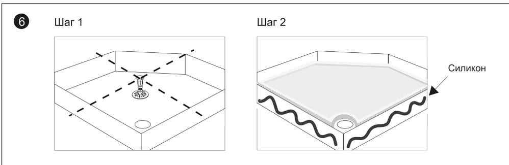
Установите ножку (Шаг 1), чтобы ножка не выступала за край душевого поддона после его установки, а затем зафиксируйте душевой поддон с помощью санитарного силикона, приложив к поверхности стороны, прилегающей к стене (Шаг 2).
