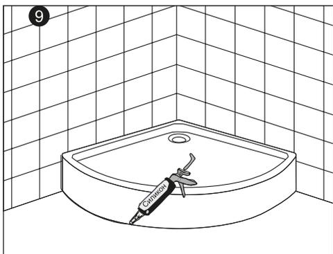
Удалите излишки силикона и клея. Место соединения поддона со стеной и полом лучше герметизировать при помощи сантехнического силикона.
