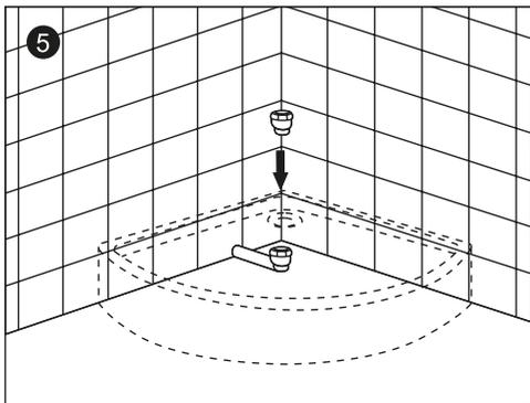
Соберите сливную трубу и нижнюю часть сифона и соедините их с канализационной системой так, чтобы сифон совпадал со сливным отверстием в поддоне. Прикрепите трубу к основанию.
