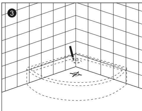
Установив душевой поддон на место монтажа, отметьте расположение сливного отверстия /сифона на полу.
