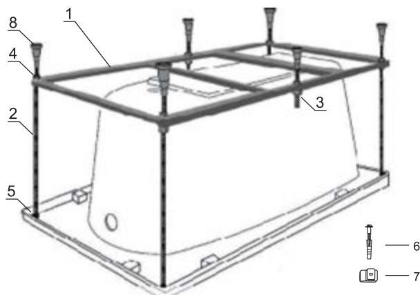
3. Установите шпильку (2) в отверстие каркаса, накрутите шпильку на пластиковые опоры (5).
