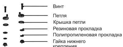
Установка верхнего крепления. Вставьте детали последовательно в керамические отверстия в соответствии с рисунком. Не зажимайте петли сильно, обеспечьте им регулируемое положение.
