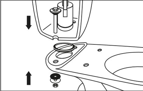
3. Наденьте уплотнительную прокладку на корпус спускной арматуры. Установите бачок с арматурой на полочку чаши унитаза и прикрепите его с помощью крепежных болтов.
