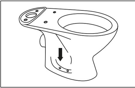
1. Закрепите чашу унитаза при помощи крепления к полу.
