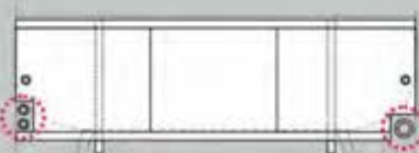
Проходит сливная труба Есть водопроводные трубы
