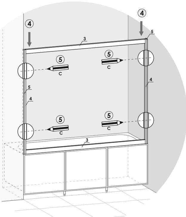
6. Просверлите стены и установочный профиль (рис.6).
