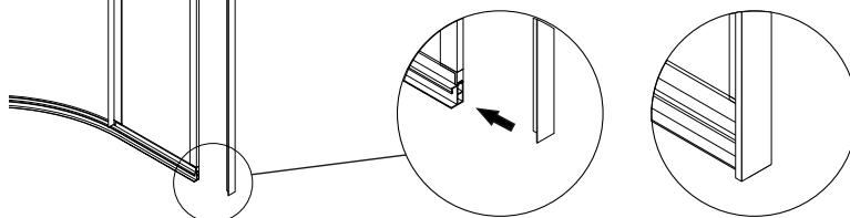
9. В наружном установочном профиле (п.3.1) просверлите три сквозных отверстия для крепления к стенам. Приложите наружный установочный профиль к стене, нанесите разметку через просверленные отверстия (рис. 9). По разметке просверлите в стенах отверстия, установите в них дюбели (п.10). См. рис. 10.
