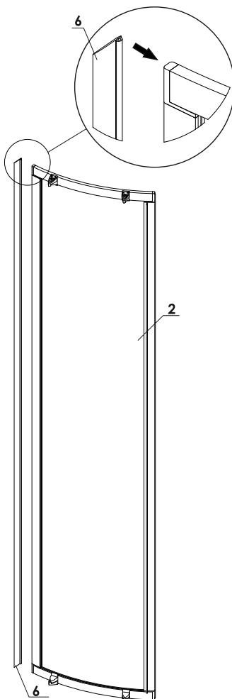
8. Оденьте наружный установочный профиль (п. 3.1) на изделие (рис.8). Поставьте душевое заграждение по месту установки, нанесите карандашом разметку в местах крепления к стенам. Используйте строительный уровень.
