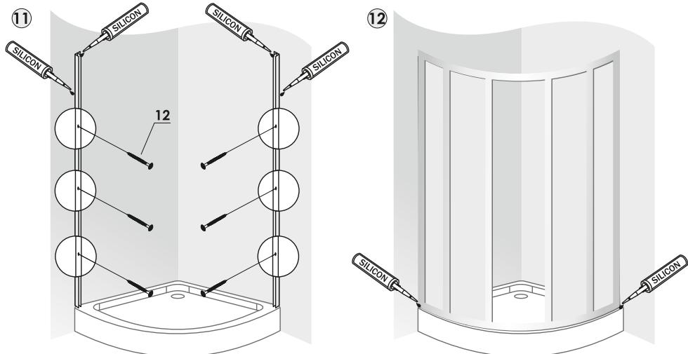
11. Нанесите герметик на душевой поддон в месте соприкосновения с нижней дугой каркаса, установите ограждение, заправив в наружные установочные профили (п. 3.1). См. рис. 12
