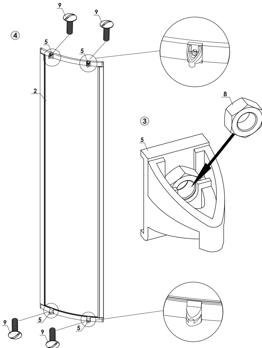
5. Заправьте подвижные панели (п. 2) в дуги каркаса (п.4), одновременно заводя верхнюю и нижнюю петли в зацепление с дугой (рис. 5), таким образом, чтобы магнитные уплотнители сходились в центре.
