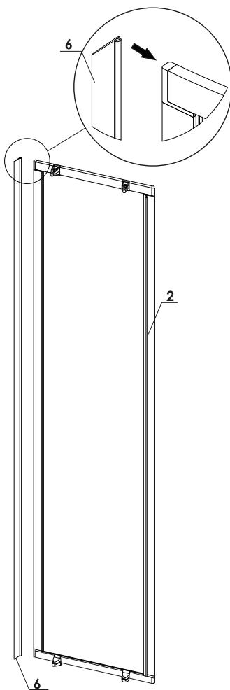
6. Оденьте установочный профиль на изделие (рис.7). Поставьте душевое заграждение по месту установки, нанесите разметку в местах крепления к стенам. Используйте строительный уровень.
