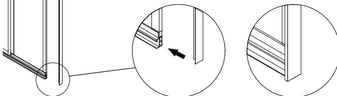
7. В установочном профиле просверлите три сквозных отверстия для крепления к стенам. Приложите установочный профиль к стене, нанесите разметку через просверленные отверстия (рис. 8). По разметке просверлите в стенах отверстия, установите в них дюбели (рис. 9).
