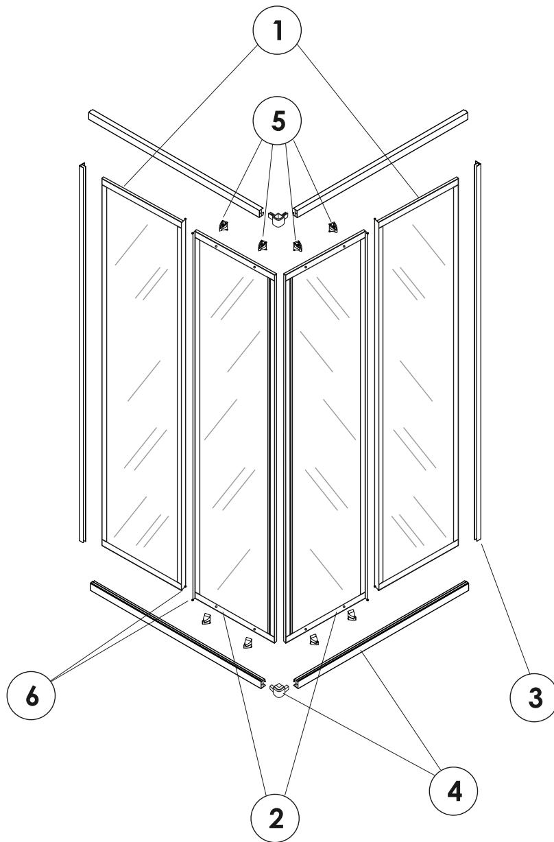
1. Закрепите направляющие дверей к панелям шурупами 4x35.
