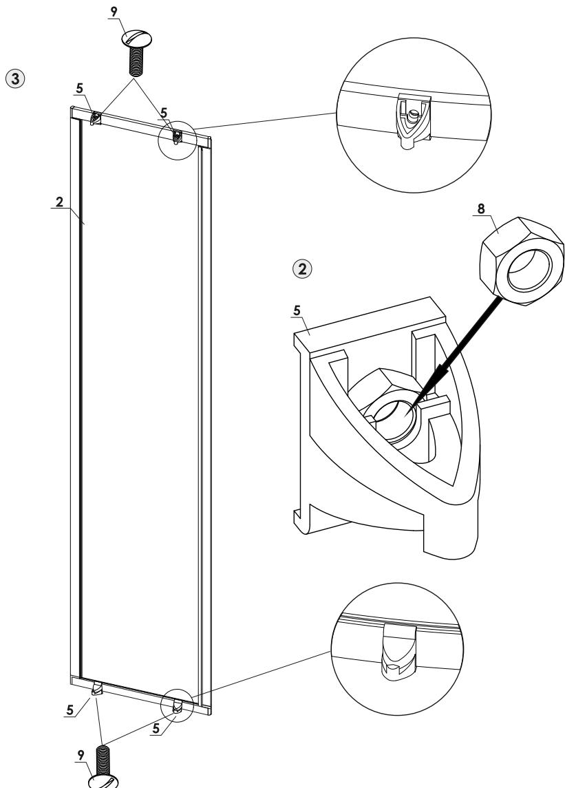
3. Заправьте дверцы в направляющие каркаса, одновременно заводя верхнюю и нижнюю петли в зацепление с направляющей (рис. 4).
