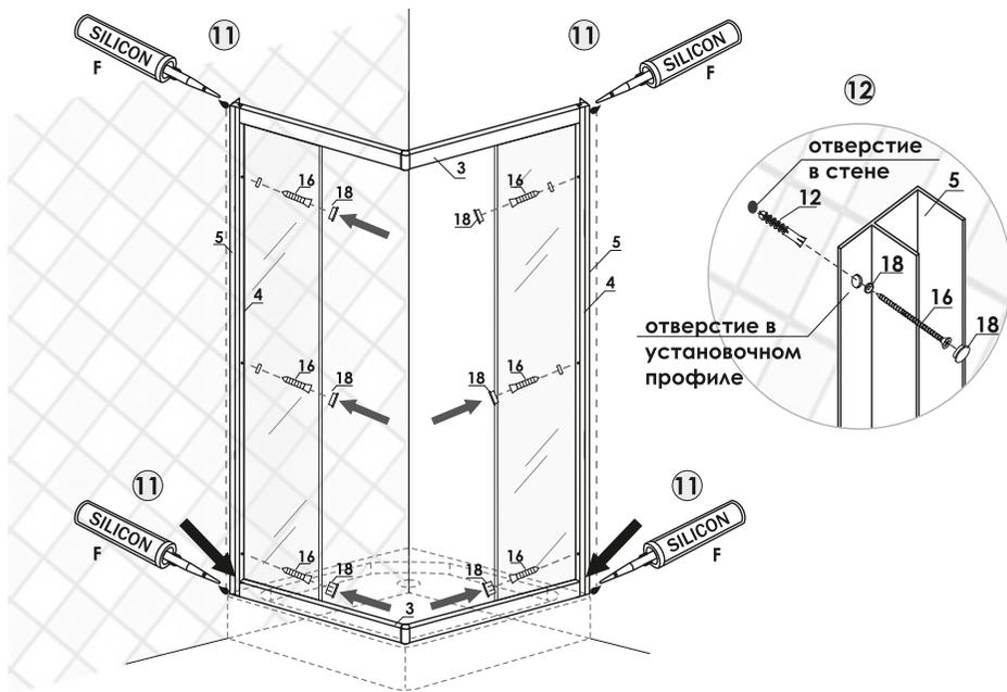
13. Закрепите между собой собранную раму и установочный профиль с внутренней стороны ширмы шурупами 3,5x9,5 (полусфера со сверлом). Используйте декоративные заглушки (рис. 13).
