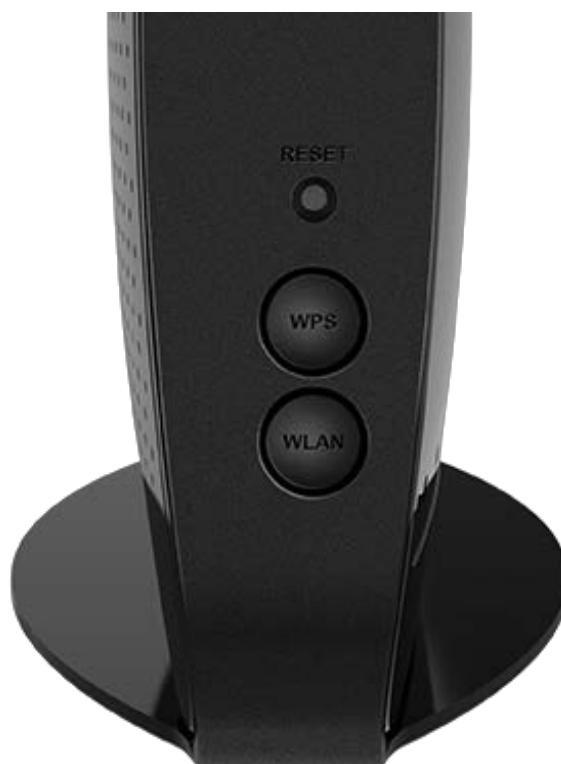
Рисунок 2. Вид левой боковой панели DWR-953.
