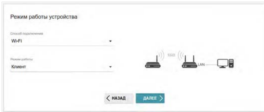
Рисунок 30. Выбор режима работы устройства. Режим Клиент .
