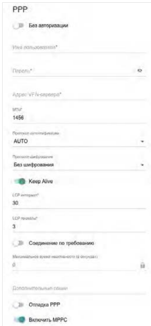
Рисунок 65. Страница добавления соединения типа PPTP . Раздел PPP .
