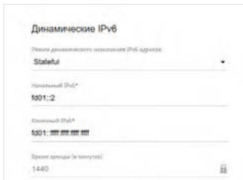
Рисунок 84. Настройка локального интерфейса. Вкладка IPv6. Раздел Динамические IPv6 .
