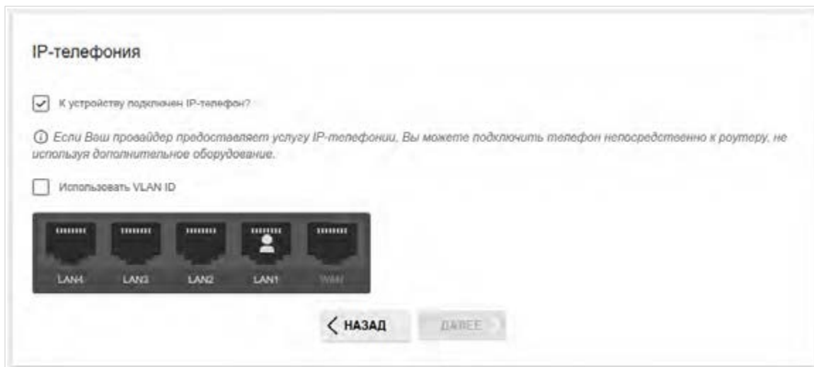
Рисунок 42. Страница выбора LAN-порта для подключения VoIP-телефона.
