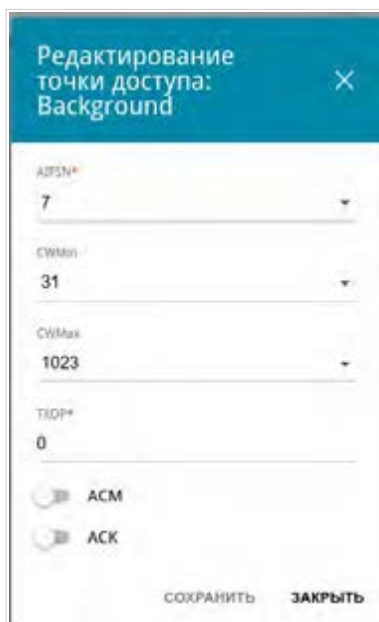
Рисунок 96. Окно для изменения параметров функции WMM.
