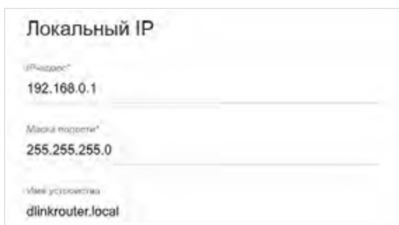
Рисунок 78. Настройка локального интерфейса. Вкладка IPv4 . Раздел Локальный IP .
