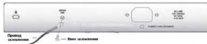
Рисунок 2. Подключение провода заземления
