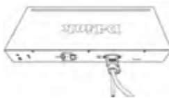
Рисунок 3-5. Фиксация кабеля питания
