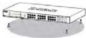
Рисунок 1. Крепление резиновых ножек
