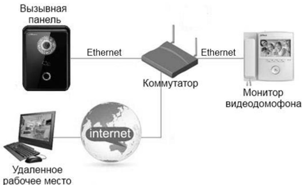
Схема подключения DHI-VTO6210B
