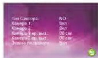
[Тип Сенсора]: Каждая камера имеет функцию записи по датчику движения. Когда датчик движения замкнет контакты, то запись в домофоне активируется, в зависимости от настройки домофона по записи клипа или снимка.
