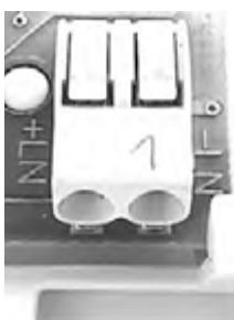
Клеммы для подсоединения абонентских проводов
