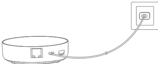
\* Если вам необходимо использовать проводную сетевую связь между Hub и маршрутизатором, используйте сетевой кабель с сетевым портом RJ45 для подключения портов локальной сети Hub и маршрутизатора, и дождитесь, чтобы загорелись оранжевые и зеленые индикаторы на стороне сетевого порта.
