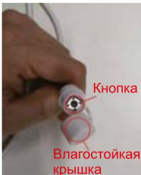
Примечание: кнопка на кабеле камеры имеет влагозащитную крышку. Закрывайте крышку, когда не используете кнопку.
