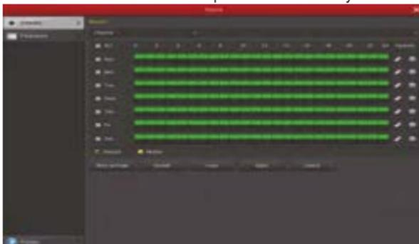
3. Настройки определения движения. Включите «Движение (Motion)» для активации записи по определению движения. Можно настроить не более 6 периодов времени каждый день. Если время обычной записи и время запись по движению перекрываются, запись может сохраняться только при обнаружении движения.
