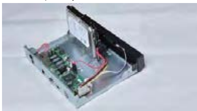
Ослабьте два верхних винта, чтобы снять крышку
