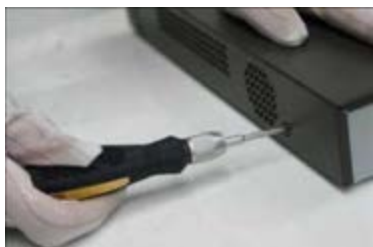
Ослабьте два верхних винта, чтобы снять крышку
