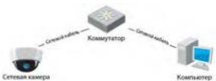
Рисунок 3-2 Соединение через коммутатор или роутер
