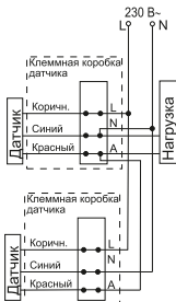
Рисунок 6 – Схема параллельного подключения датчиков движения
