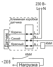
Рисунок 8 – Схема подключения датчиков с контактором КМИ
