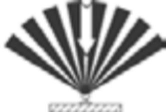
При выборе места установки следует исключить из зоны обнаружения датчика объекты, которые могут приводить к его ошибочным срабатываниям. Для этого необходимо избегать установки датчика вблизи зон температурного возмущения (кондиционер, отопление) и вентиляторов.
